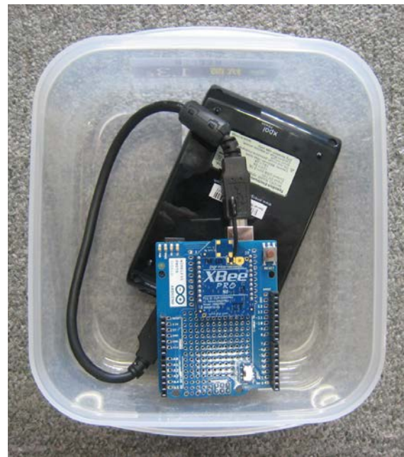
XBee Pro + Arduino UNO IEEE 802.15.4 100bytes 1s interval Bitrate: 250kbps
